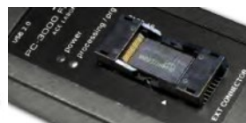
■HDD/SSD/フラッシュ復旧装置 ■フラッシュ製品用USBライトブロッカー ■EMMCアダプター
